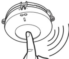
2. Nach dem Test kontrollieren, dass die rote Leuchte etwa alle 40 Sekunden aufleuchtet.
