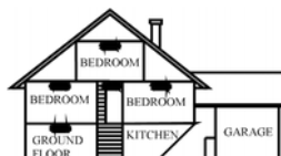
Abb. 3: AUFSTELLUNGORT RAUCHMELDER FÜR EIN MEHRGESCHOSSIGES WOHNHAUS
